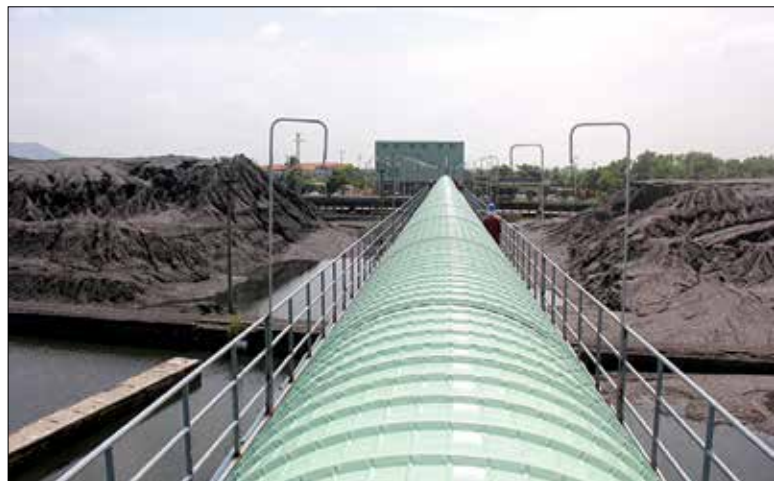
Đầu tư các tuyến băng tải vận chuyển than góp phần bảo vệ môi trường. Trong ảnh: Hệ thống băng tải vận chuyển than từ kho than Khe Ngát ra cảng Điện Công, Uông Bí.
